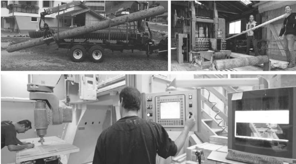
Fig. 2 - Sopra: Segheria a Gries im Sellrain (2017); Michael Bacher e Walter Klasz. Sotto: fresatura dei nodi lignei per la Snow-Cloud tramite macchina a controllo numerico nella sede della compagnia locale Huter&Söhne.
