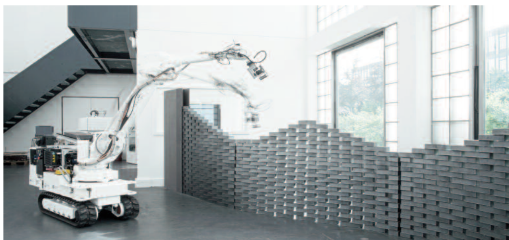
Figg. 11, 12 - Una quinta di mattoni, la cui tessitura è assemblata da un robot (© NCCR Digital Fabrication), e la Galleria d'arte nel Shanghai's West Bund District, il cui prospetto con trama in mattoni è stato posato in opera da un robot (Archi-Union Architects, 2016).
