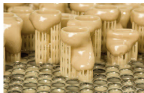
Figg. 17-19 - Fasi del processo di stampa stereolitografica di alcuni auricolari prodotti dalla azienda danese Windex (dal sito www.disruptiveinnovation.se/?tag=stereolithography , 2016).
