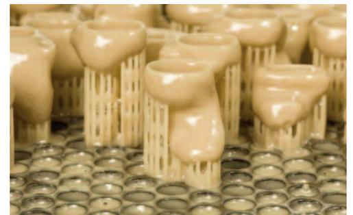
Figg. 17-19 - Fasi del processo di stampa stereolitografica di alcuni auricolari prodotti dalla azienda danese Windex (dal sito [www.disruptiveinnovation.se/?tag=stereolithography](http://www.disruptiveinnovation.se/?tag=stereolithography), 2016).
